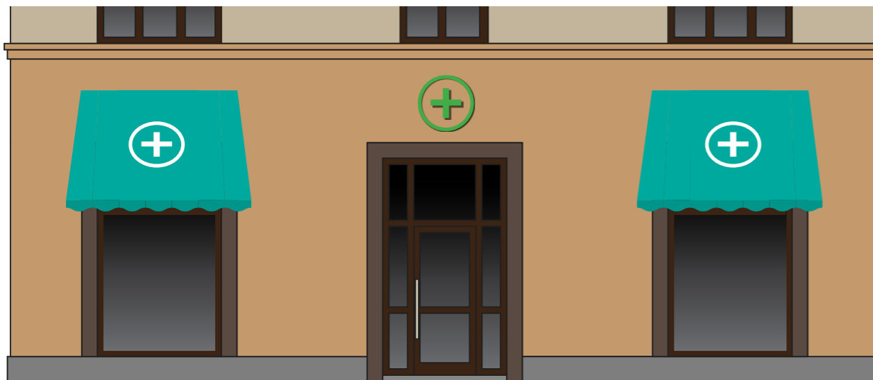
Маркизы установлены выше оконных проемов за счет площади, отведенной под вывески
