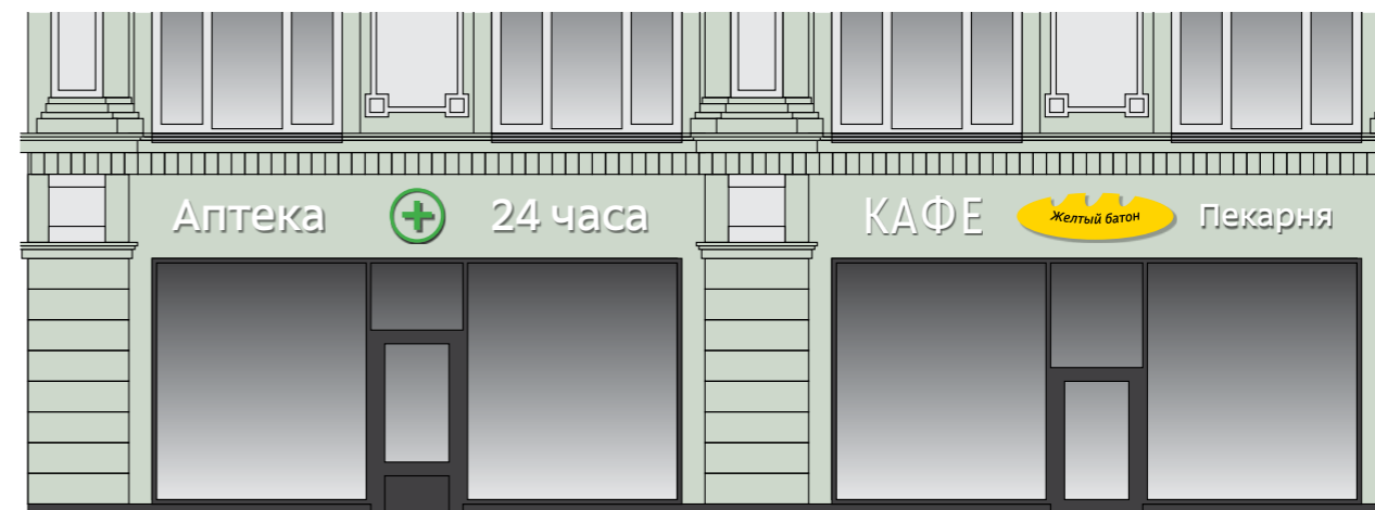
Вывески с плоской подложкой можно заменить на вывески без подложки на всем фасаде здания
