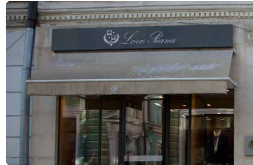
Удачно размещенные маркизы визуально увеличивают высоту витрин. Цвет маркизы повторяет цвет здания, архитектурные детали фасада маркиза не закрывает
